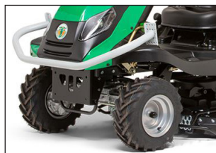
AS-Bereifung vorne: 6x6.50-8, hinten: 20x10.00-8
