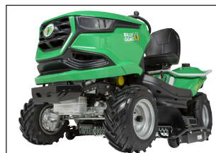
AS-Bereifung vorne: 6x6.50-8, hinten: 20x10.00-8
